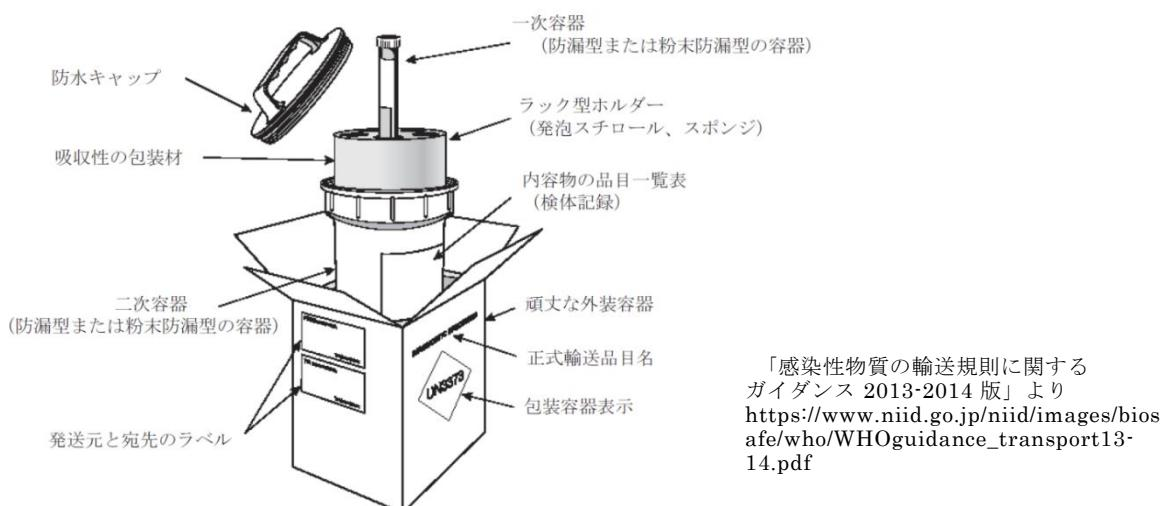
図 III-7 カテゴリーB の感染性物質の三重包装手法の包装の例
