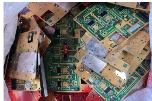
電子スクラップの例：プリント配線板
