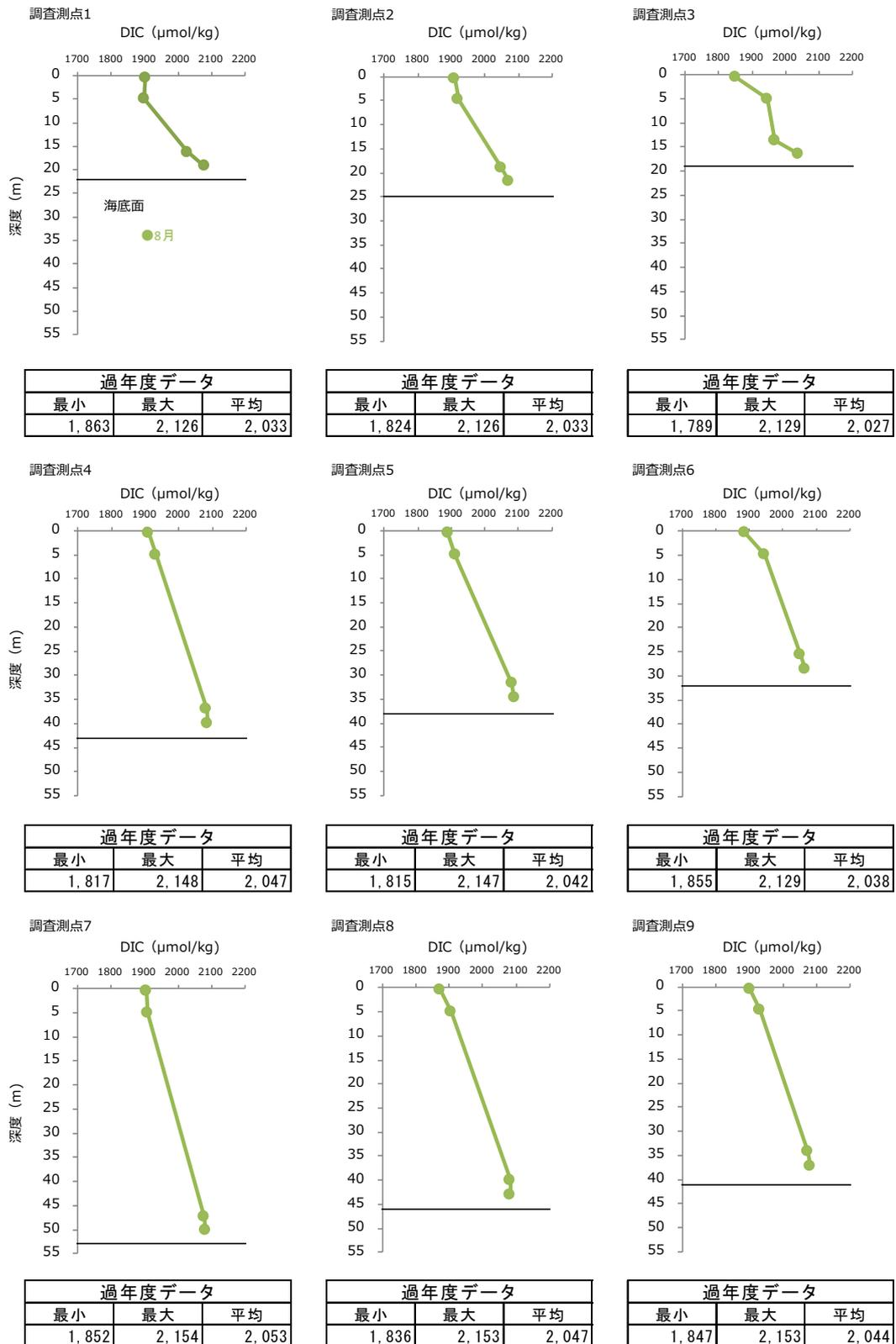
図-10 2022年度夏季 各調査測点における全炭酸（DIC）濃度の鉛直プロファイル
