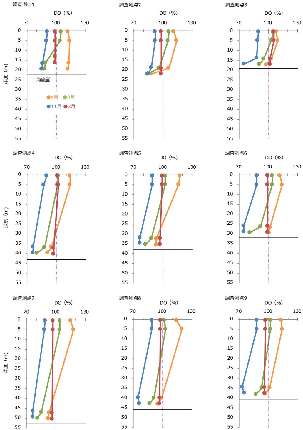
図-15 2021年度 各調査測点における溶存酸素 (DO) 飽和度の鉛直プロファイル
