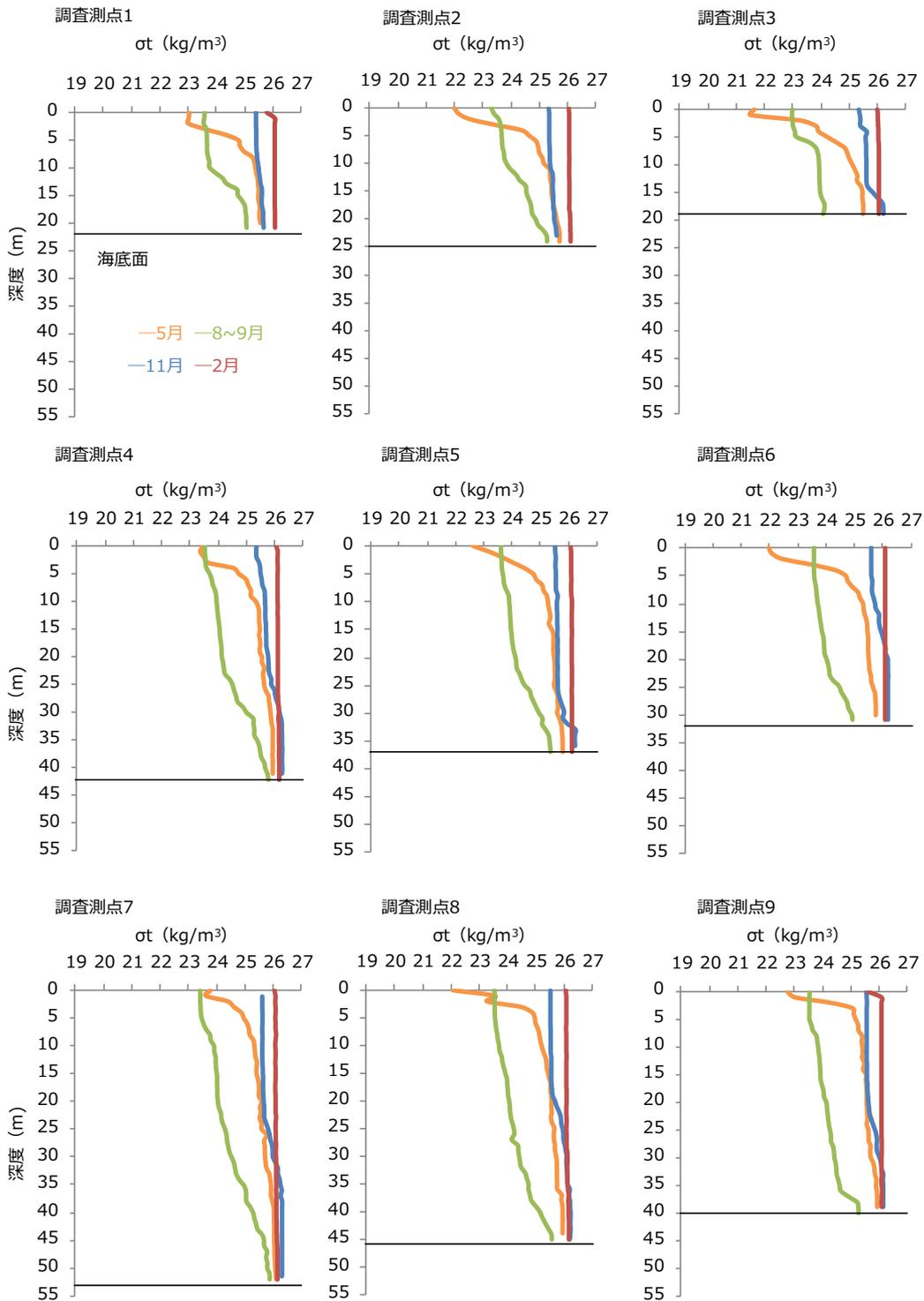
図-5 2021年度 各調査測点における海水密度 ( $\sigma_t$ ) の鉛直プロファイル
