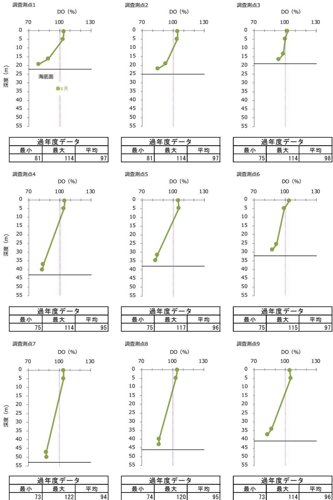
図-16 2022年度夏季 各調査測点における溶存酸素 (DO) 飽和度の鉛直プロファイル
