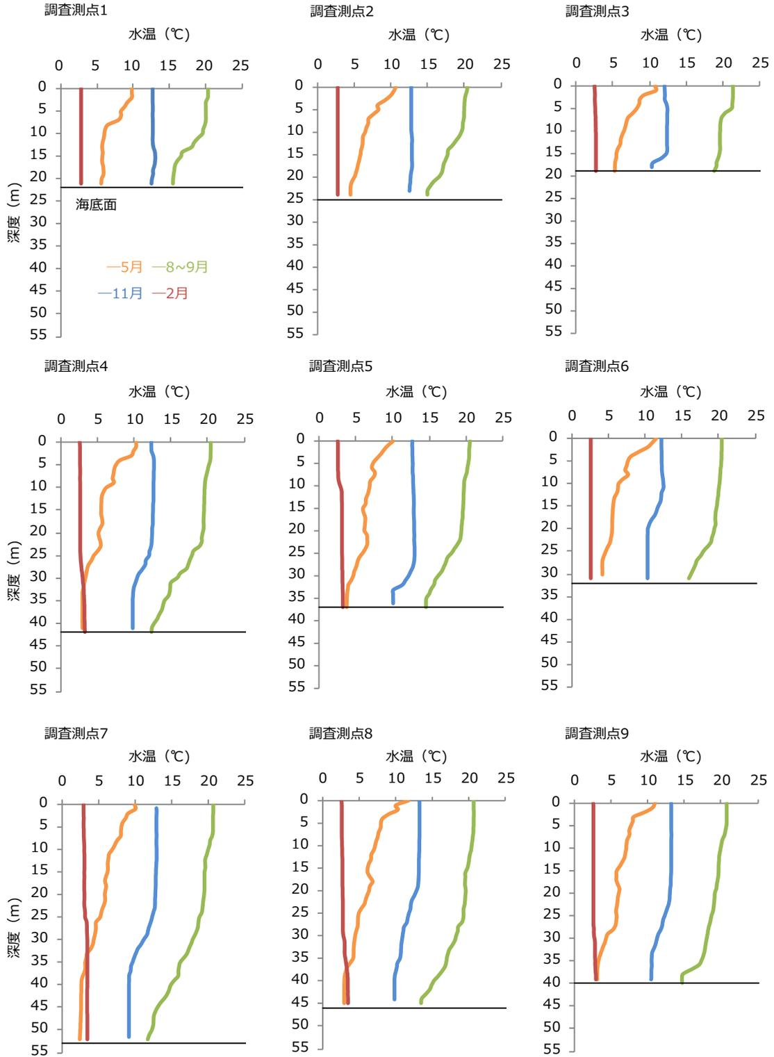
図-1 2021年度 各調査測点における水温の鉛直プロファイル
