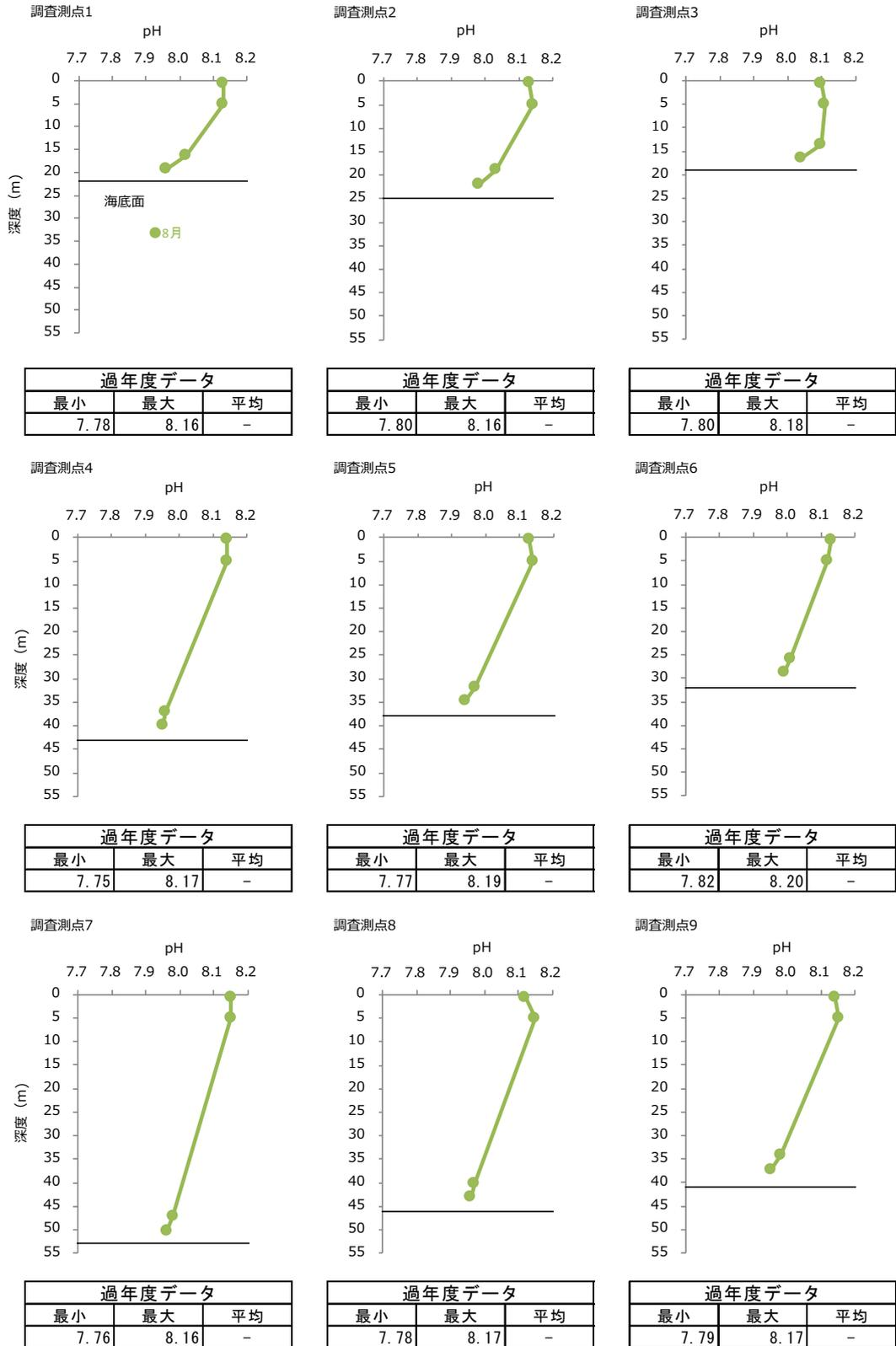
図-12 2022年度夏季 各調査測点における pH の鉛直プロファイル
