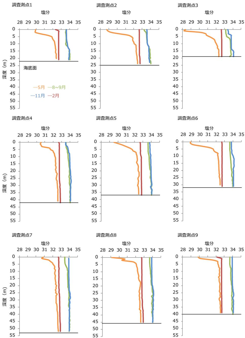
図-3 2021年度 各調査測点における塩分の鉛直プロファイル
