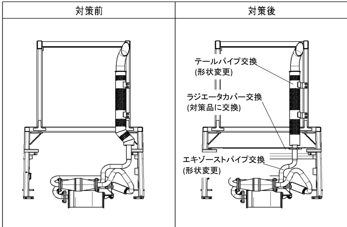
内燃式フォークリフトにおいて、特別受注仕様で装着したパーチカルエキゾーストパイプの形状が不適切なため、排気圧力が一酸化炭素発生防止装置の装置型式メーカーの届出の値を超えており、排出ガス規制に適合しないおそれがある。
