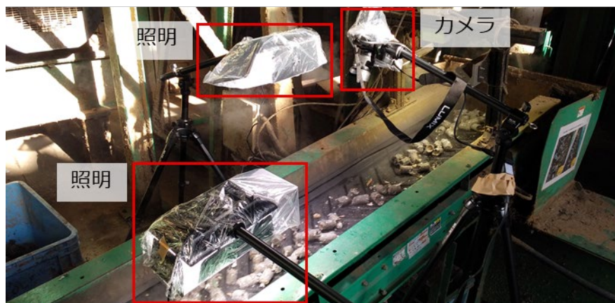
図 2-3 撮影時の機材設置(詳細)
