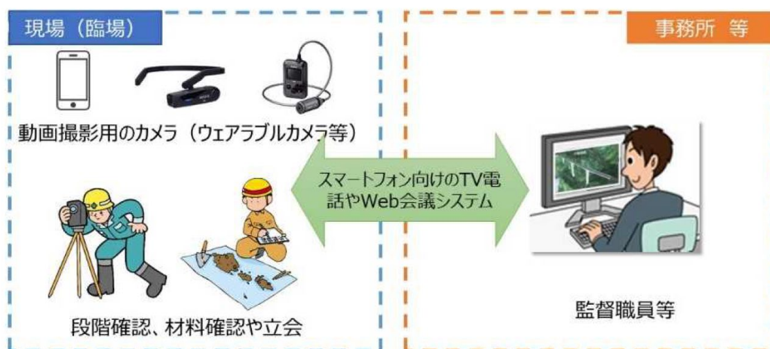
図 1-20 遠隔臨場における機器構成例
