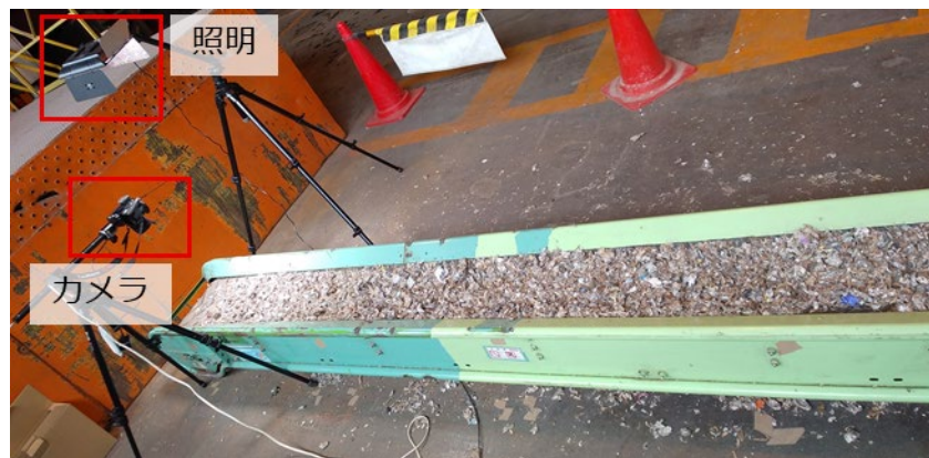
図 2-10 異常品撮影の機材配置
