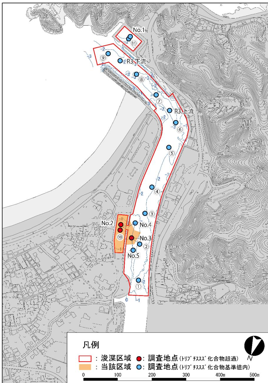
図-4.1 海洋投入処分しようとする水底土砂の浚渫区域と試料採取位置
