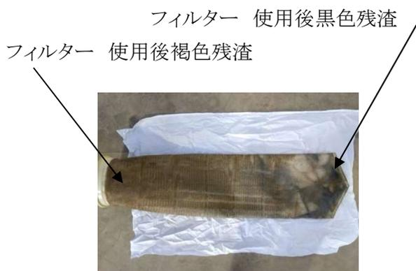
図 18 二次ストレーナの使用后フィルター
