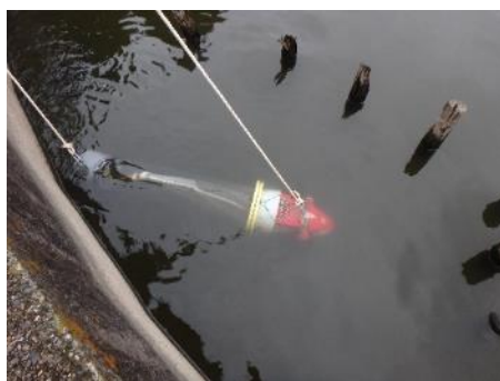
図 4-7 動力通水装置での採取の様子
