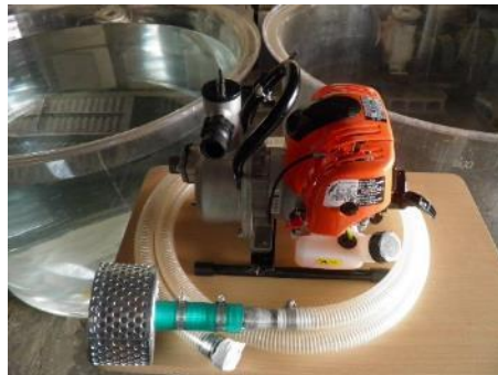
図 4-8 ポンプ及びストレーナの例
