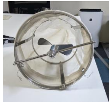
図 3-6 ②金属フレームによる固定の例
