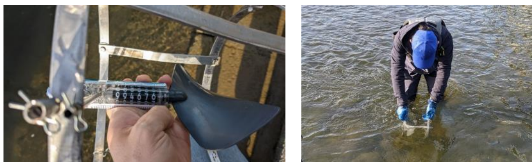
図 3-12 ろ水計を使用した流速の測定
