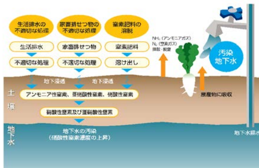
図-6 硝酸性窒素の地下水汚染のしくみ 2)
