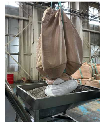
パレットがパレット製造機に投入される
