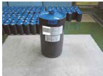
①水銀等が飛散・流出する恐れのない容器への保管
