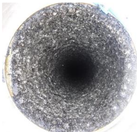
図 4-3-8 減湿コンデンサ機器内部に析出したタール
