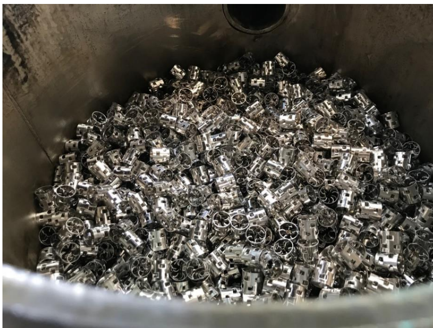
図 4-3-11 オイルスクラバー充填物の充填状況
