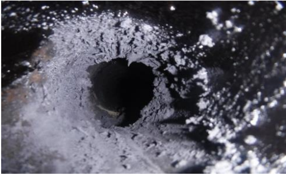
図 5-3-4 対策後チャー付着状況
