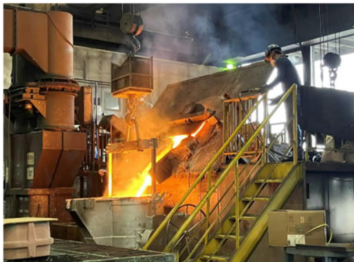
高周波炉(電気炉)からの注湯の様子
