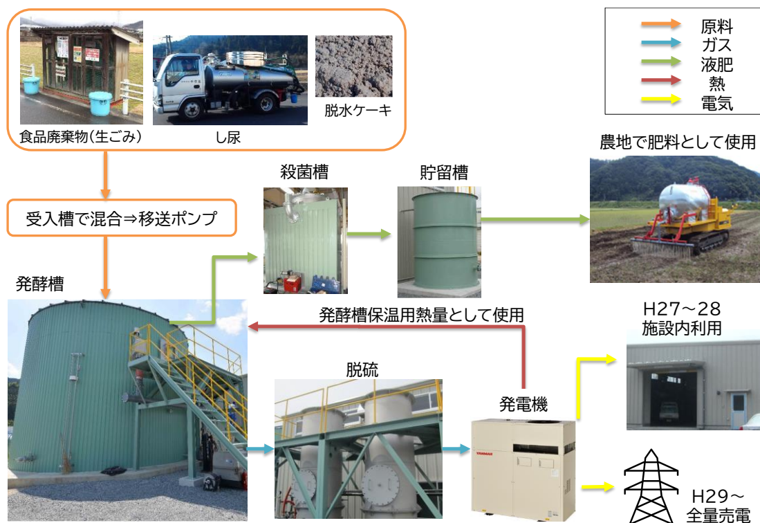
図 1-4 既存プラントの概要フロー
