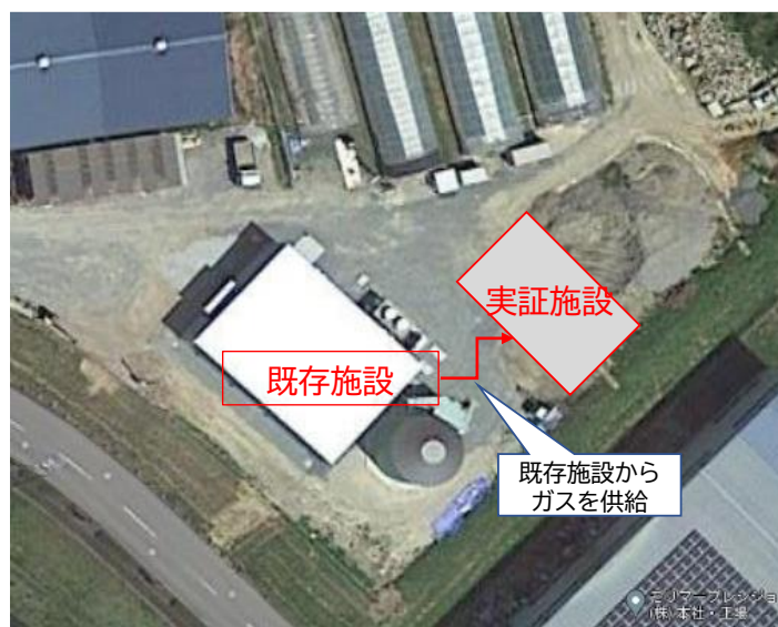
図 1-5 既存プラントと本実証設備の配置
