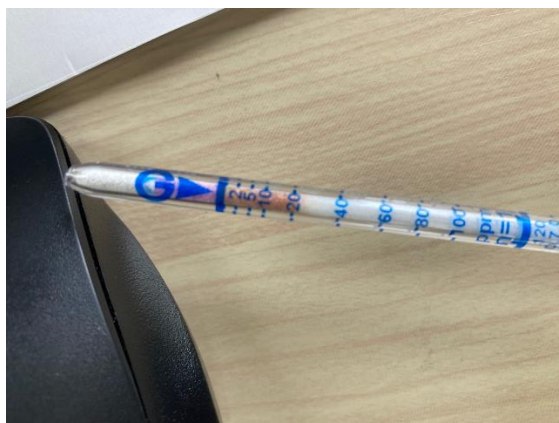
図 2-10 芳香族を検知する検知管（活性炭フィルタ入口分析時）
