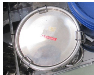
水銀を樹脂製容器に入れ、ステンレス製密閉缶に収納
