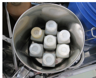
水銀を樹脂製容器に入れ、ステンレス製密閉缶に収納
