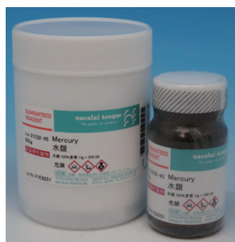
(左) 褐色ガラス瓶に密閉したものを、さらに緩衝材の入ったポリエチレン製の容器に密閉 (右) 水銀を入れた容器を、転倒防止のため、中に仕切りのある段ボールに収納
