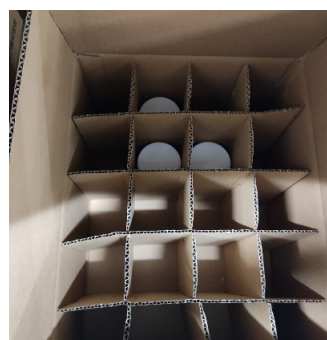
(左) 褐色ガラス瓶に密閉したものを、さらに緩衝材の入ったポリエチレン製の容器に密閉 (右) 水銀を入れた容器を、転倒防止のため、中に仕切りのある段ボールに収納
