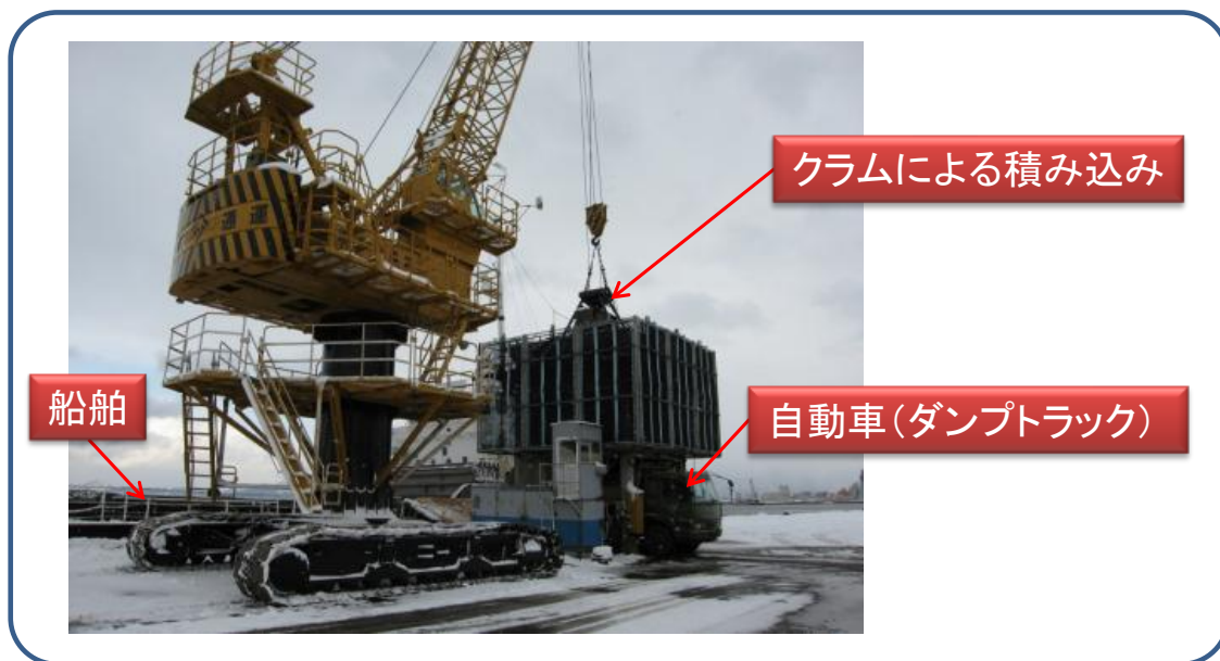
図 3.6.6-1 埠頭における積替え作業の例
