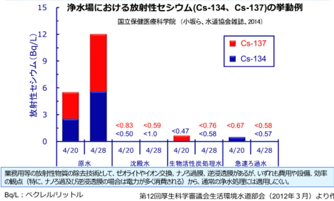
2011年4月時点で福島県内の浄水場の原水、沈殿水、生物活性炭処理水、急速ろ過水について放射性セシウム濃度を測定したところ、原水に低濃度の放射性セシウムが流入していた場合でも、その放射性セシウムは沈殿の段階で土壌に付着して減少するというデータが得られました。
