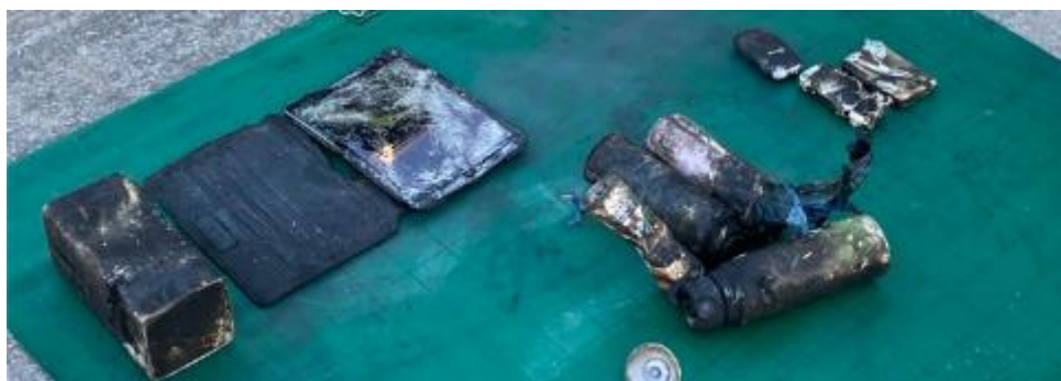
図 5-60 1月5日の火災の原因だと考えられるスプレー缶、リチウム蓄電池使用機器(埼玉県坂戸市)
