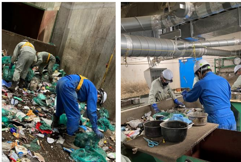
図 5-17 手選別作業の様子(左:破袋機投入前、右:破袋後)
