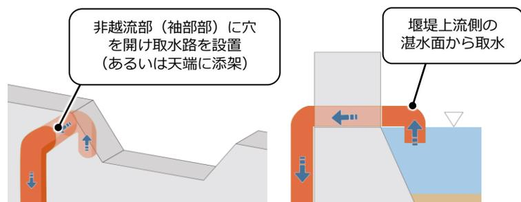
図7.3 直接取水方式（サイフォン式）
