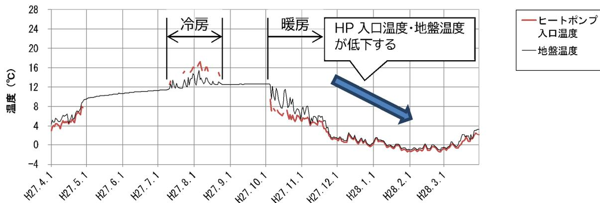
※地盤温度は、地中熱交換井地盤温度(5 深度測定)の平均値。
