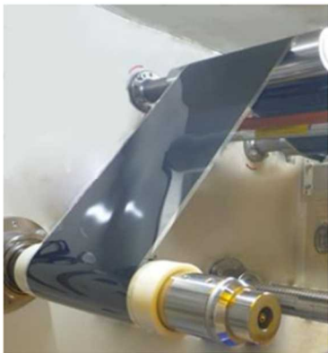
ロールtoロールによる製造
