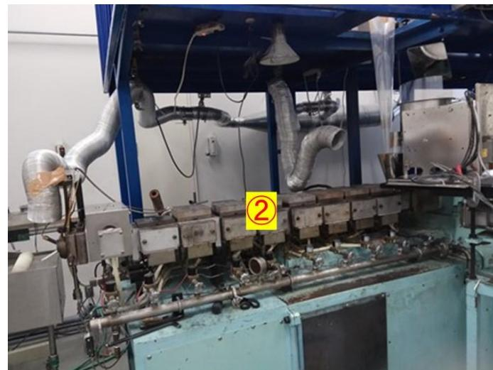
図 3-5 ツインスクリューによる混練
