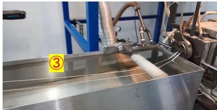
図 3-6 ストランドの水冷
