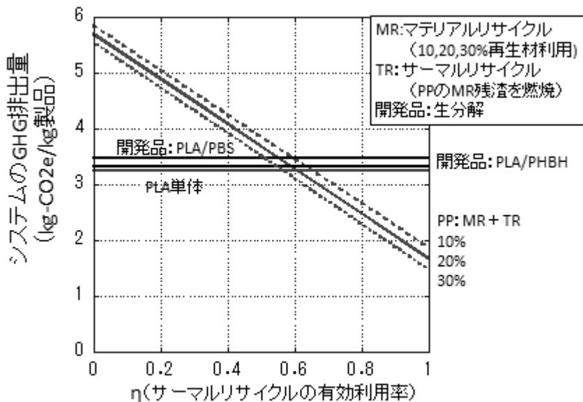
図 4-61 開発品とベースライン (PP) の各種リサイクル適用による GHG 排出量
