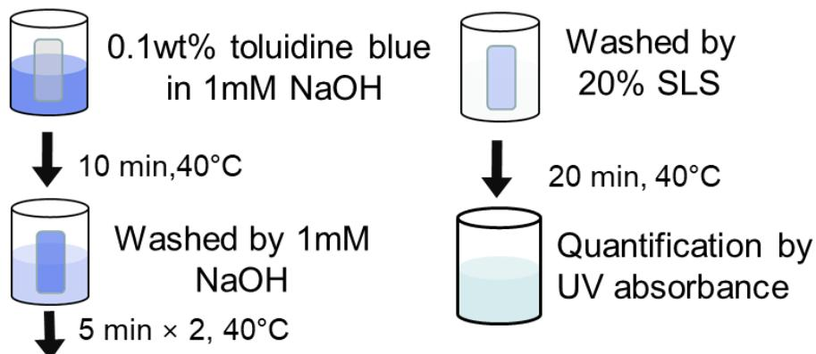
図 2-2. トルイジンブルーを用いたカルボン酸選択的染色法
