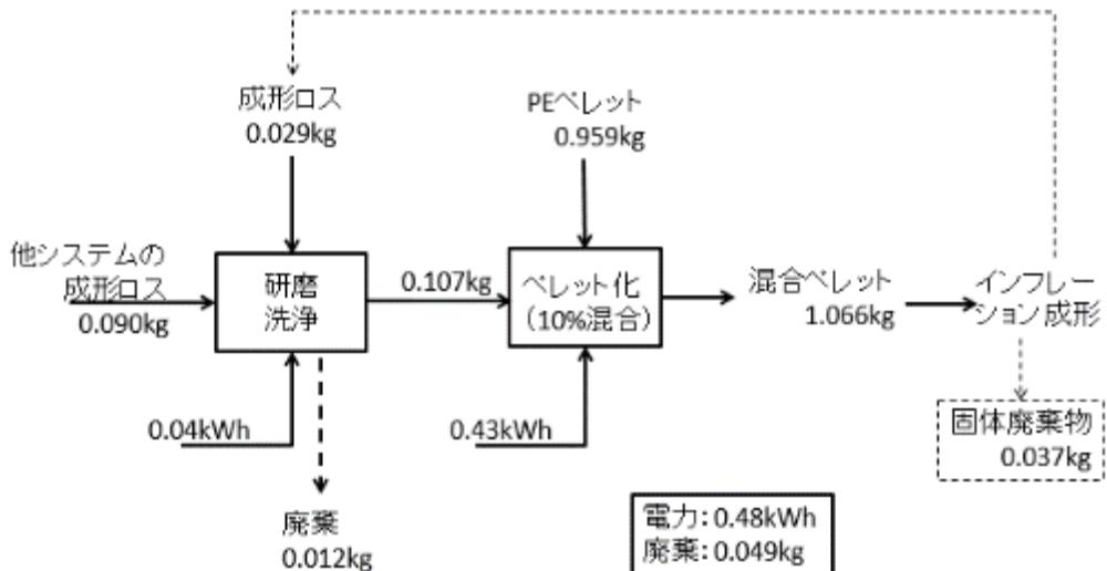
図4-54 産廃PEを10%リサイクルした再ペレット化のモデル
