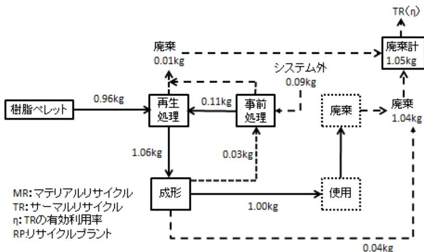
図 4-56 PE フィルム製造、リサイクルフロー
