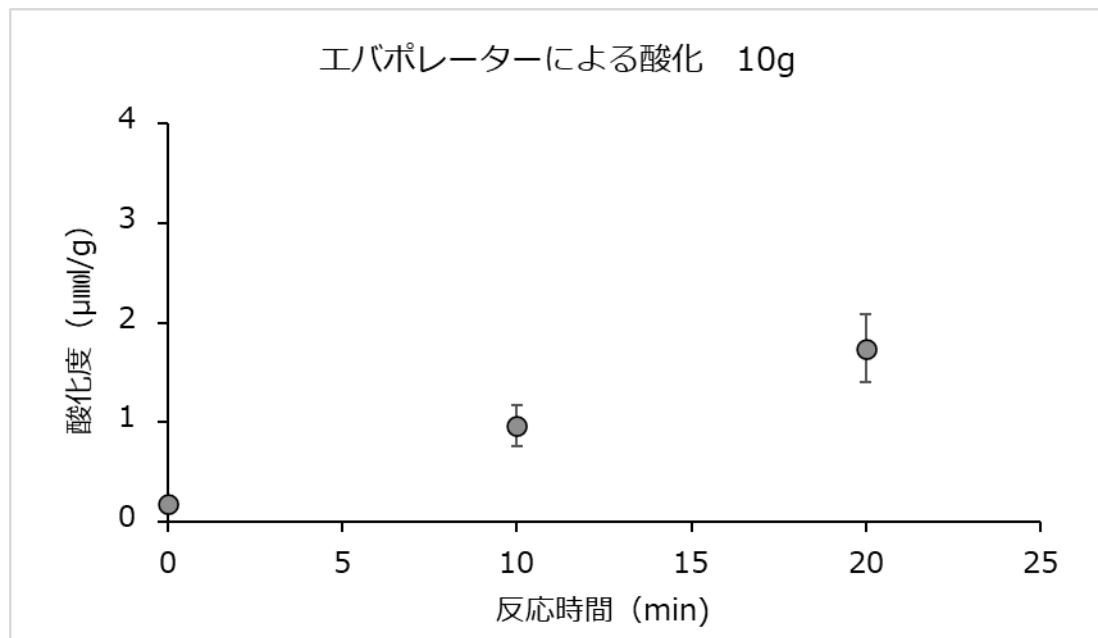
図 2-9. エバポレーターによる酸化 10g
