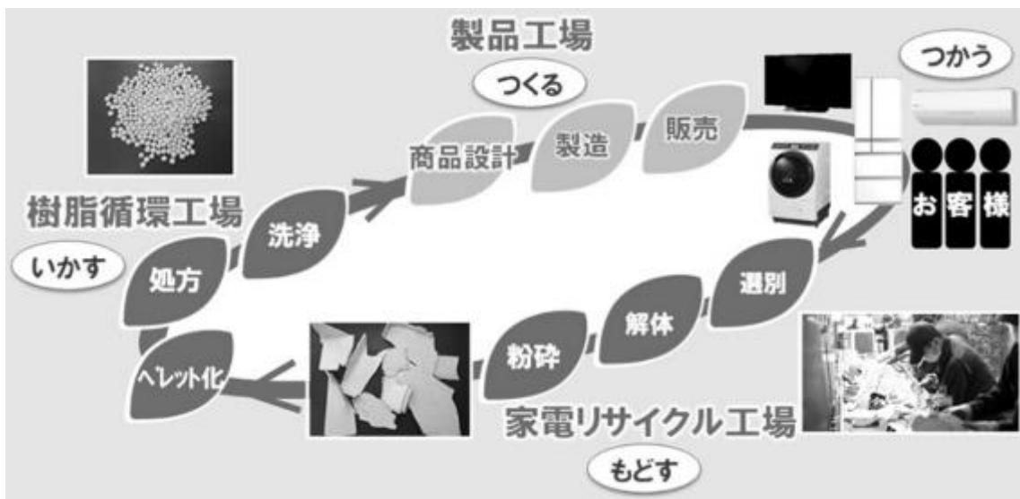
図 4-15 パナソニックの家電リサイクル（再生樹脂原料製造のフロー）
