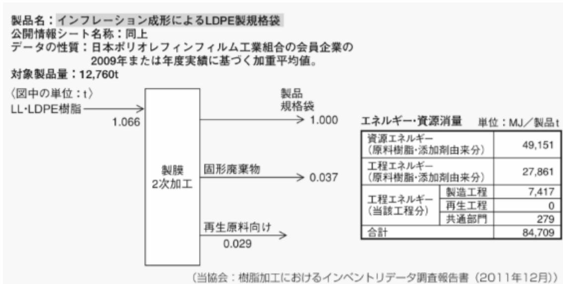
図 4-52 インフレーション成形によるフィルム製造のインベントリデータ
