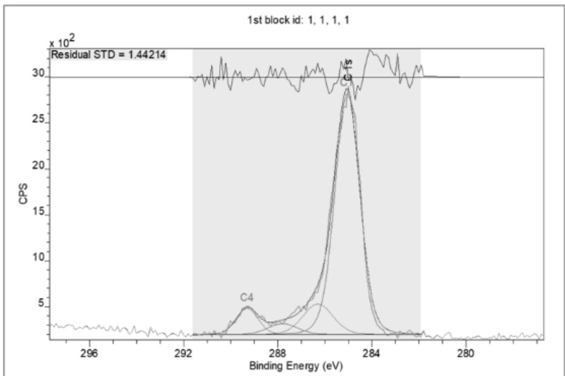
図 2-6. 未処理の PHBH フィルムの C1s スペクトル
