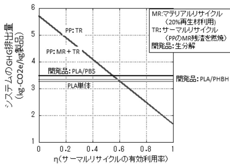
図 4-58 開発品とベースライン（PP）の各種リサイクル適用による GHG 排出量
