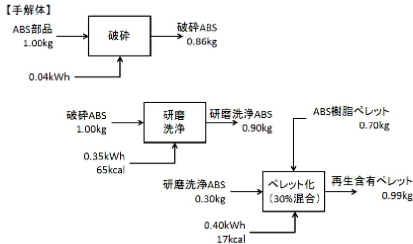
図4-53 使用済みABS部品をリサイクルした再ペレット化のモデル
