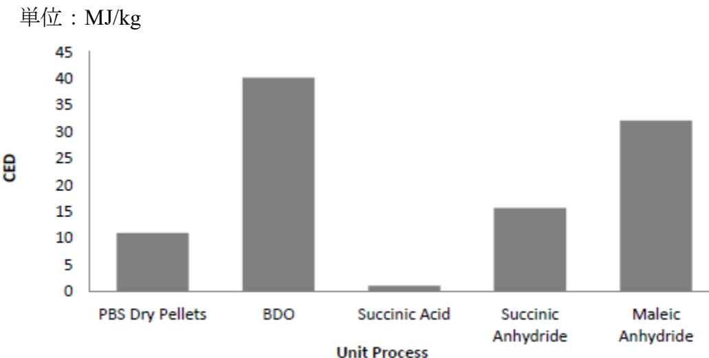
図 4-41 1kg のバイオ PBS ペレット生産までのエネルギー消費量
