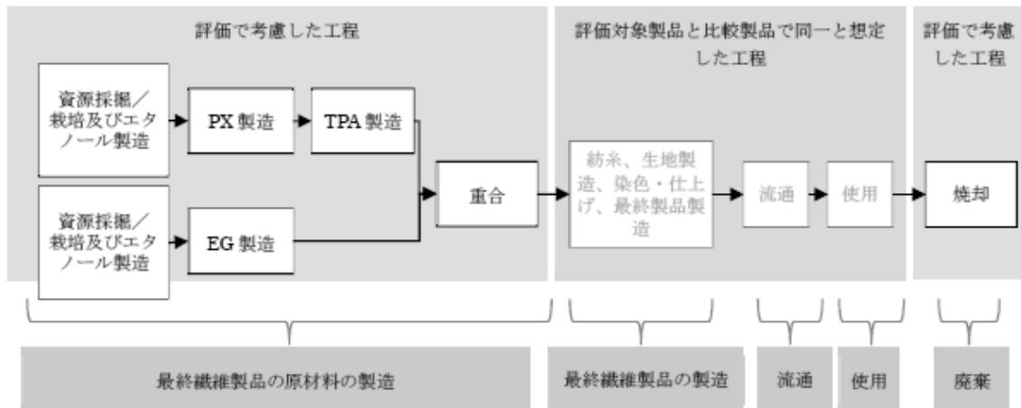
図 4-31 PET の LCA 実施の製品システム
