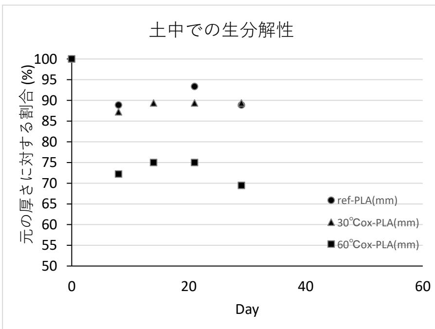
図 3-7 ②の箇所の厚み変化
