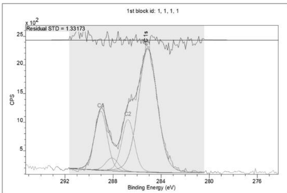
図 2-7 酸化処理①の PHBH フィルムの C1s スペクトル
