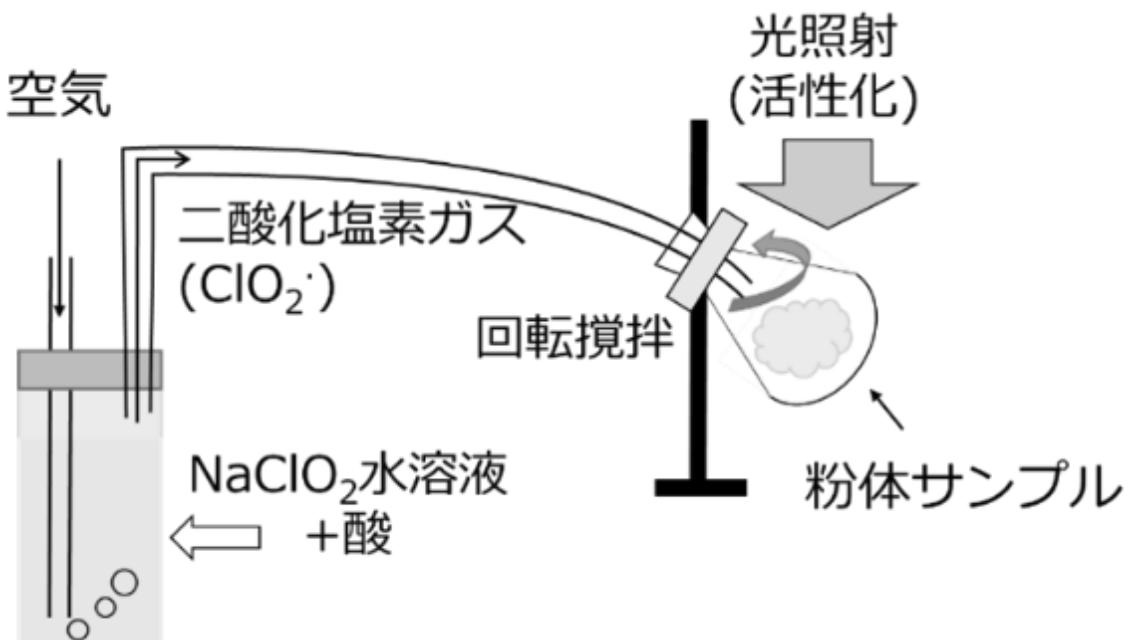
図 2-8. 粉体酸化処理装置の模式図
