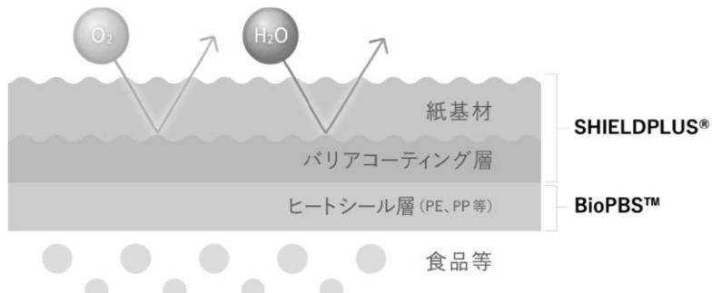
図 4-44 循環型包装材の層構造イメージ
