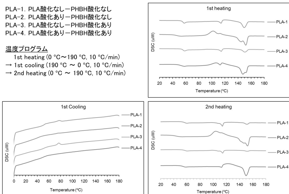
図3-3 PLA-PHBHブレンドフィルムのDSC測定結果
