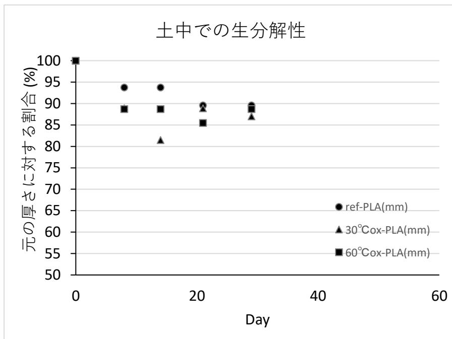
図 3-8 ③の箇所の厚み変化
