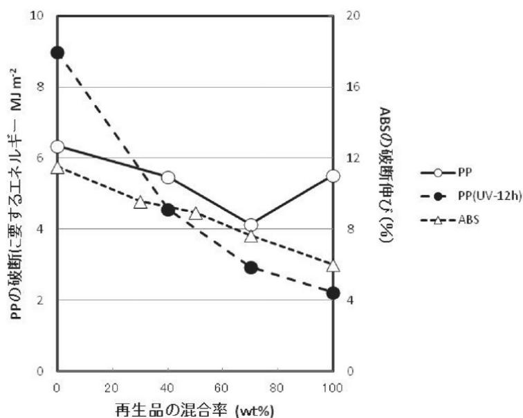
図 4-62 再生材の混合率と PP,ABS の破断伸びの関係[51]
