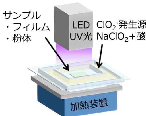
図 2-1. 反応装置図
