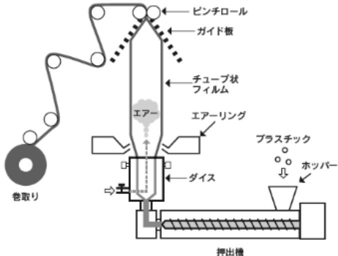
図 4-51 インフレーション成形の模式図
