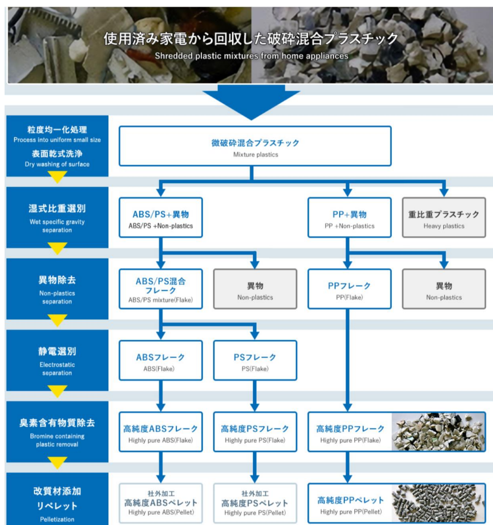
図 3-19 三菱電機の再生 ABS 樹脂生産フロー
