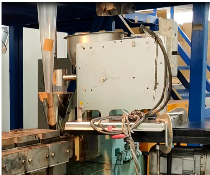
図 2-28 ①EuTPI フィーダーと③二軸押し出し機の原料入口
