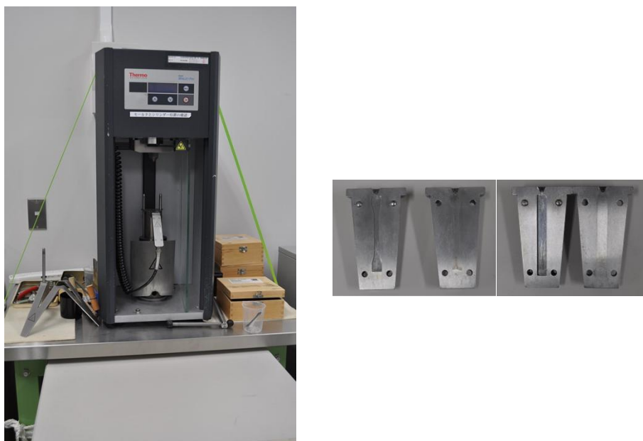
図 2-34 小型射出成形機と金型 2 種（ダンベル型、短冊状金型（右））
