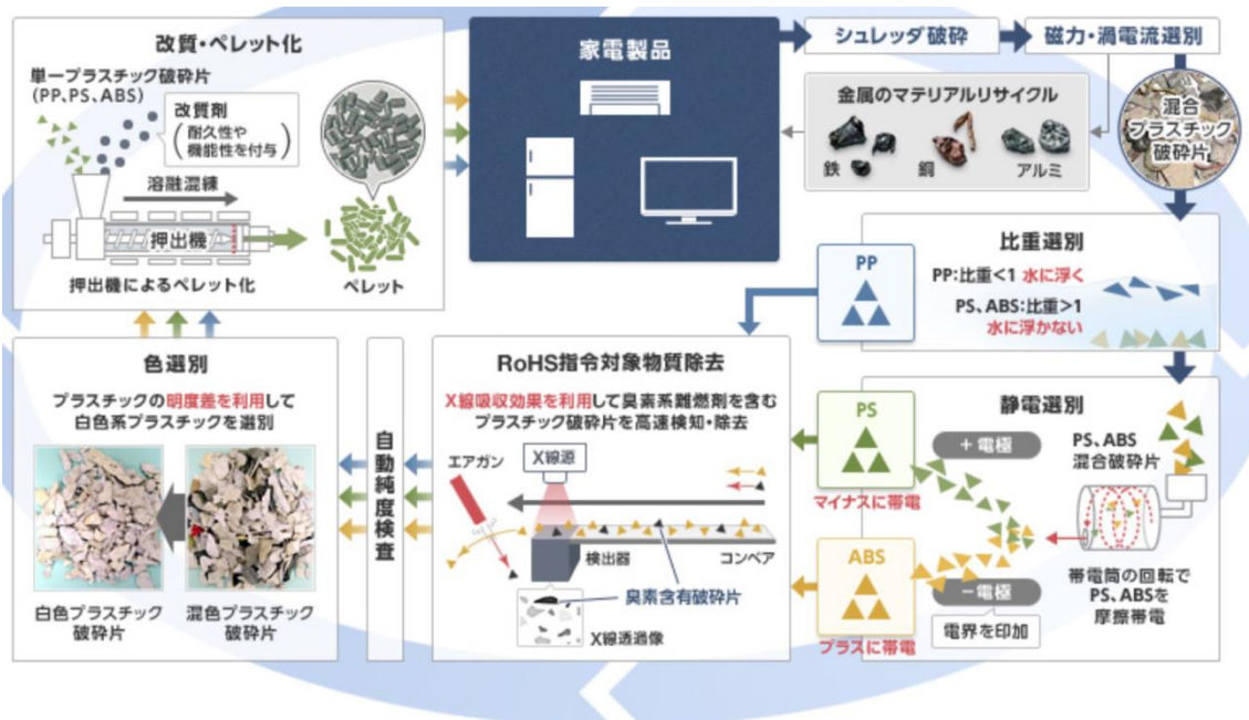
図 3-12 三菱電機の家電リサイクル（再生樹脂原料製造のフロー）
