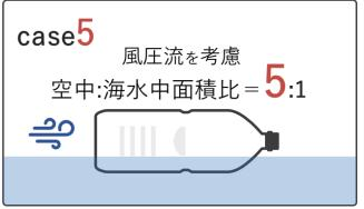
ゴミの浮遊状態(空中:水中面積比=下式のAa/Aw)を変化させてシミュレーションを実施している
