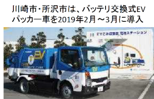
EVゴミ収集車(電池交換型)と電池ステーション
