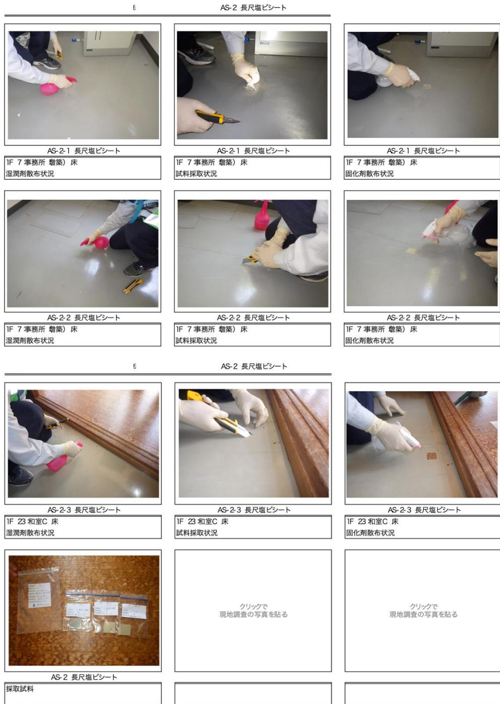
非意図的に混入した石綿の有無も確認することが必要であることから、分析方法にかかわらず、同一と考えられる建材の範囲ごとに、原則として1検体につき3箇所以上から試料を採取する（変動性・均一性の適切な考慮）。試料採取状況写真は、採取地点の全てで撮影する。
