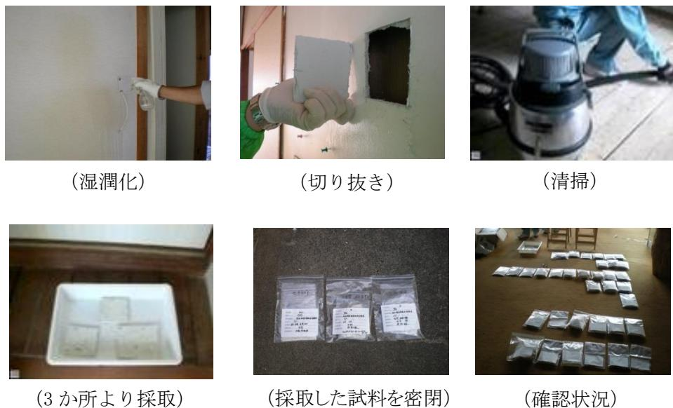
図 I-5-8 サンプリング例（成形板）
