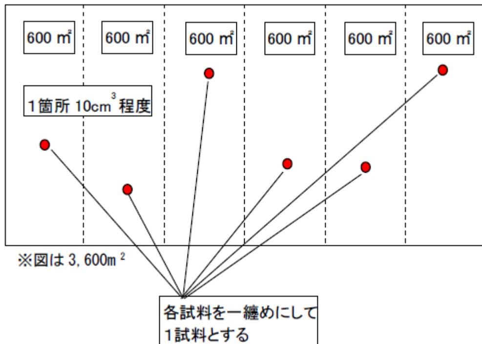
図 I - 5 - 3 試料採取説明図（平屋建ての建築物：床面積3,000m<sup>2</sup>以上）
