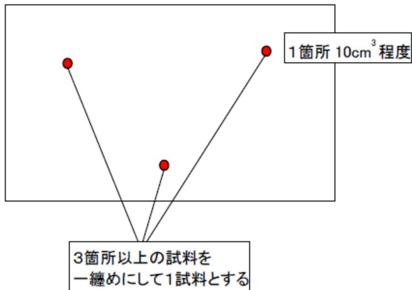
図 I - 5 - 2 試料採取説明図（平屋建ての建築物：床面積3,000m<sup>2</sup>未満）
