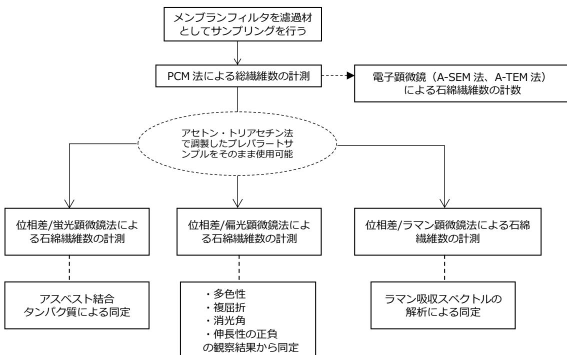
図5.3.1 メンプランフィルタで採取した試料の測定方法
