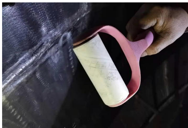
写真 3.1.5-3 粘着性ペーパーローラーによる異物検査
