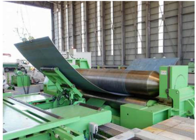
円筒タンク用専用ベンディングローラー
