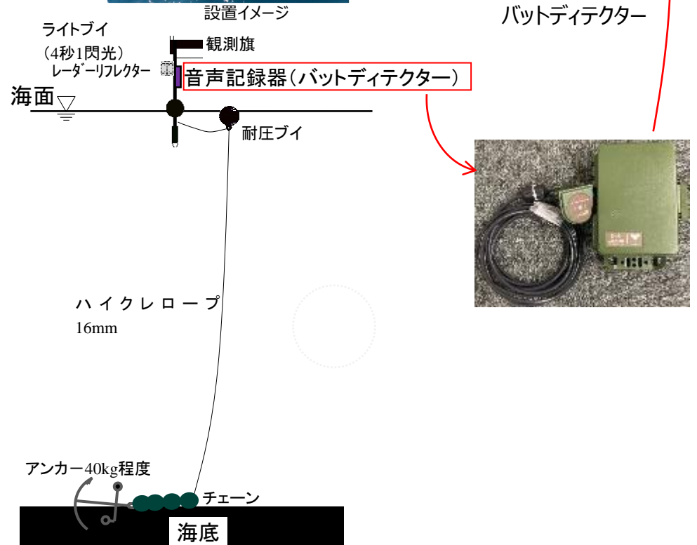
小型洋上ブイによる調査の機器設置イメージ
