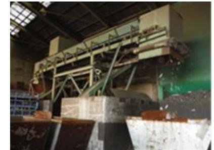
②破碎されたプラスチックを廃プラスチック炭化施設へ搬送
