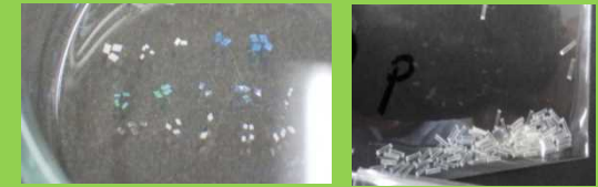
外洋と内湾を模した2種類の標準試料を用意。マイクロプラスチックと自然物の粒子を含む。
