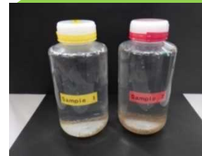
外洋と内湾を模した2種類の標準試料を用意。マイクロプラスチックと自然物の粒子を含む。
