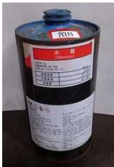
図 1 水銀を貯蔵する容器の例（エポキシ系塗料で内面塗装された鋼鉄製容器）
