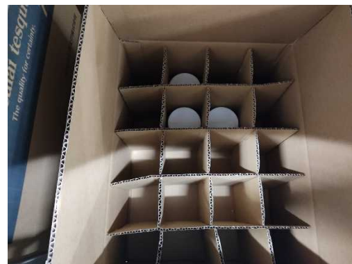
図 14 転倒防止のため、段ボールの中に仕切りがある
