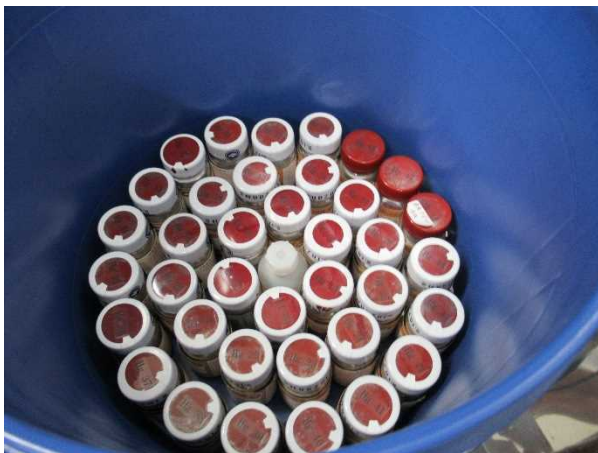
図 6 試薬水銀容器はガラス製試薬瓶に入れ、樹脂製パール缶に収納している。
