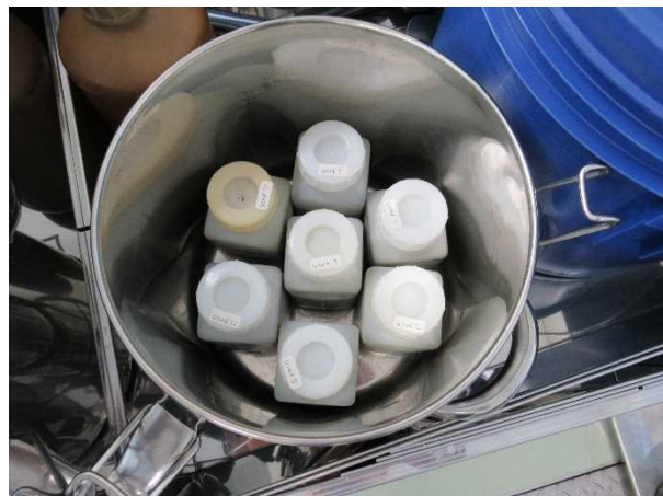
図 7 分析で使用した水銀は樹脂製サンプル瓶に入れ、ステンレス製密閉缶に収納している。
