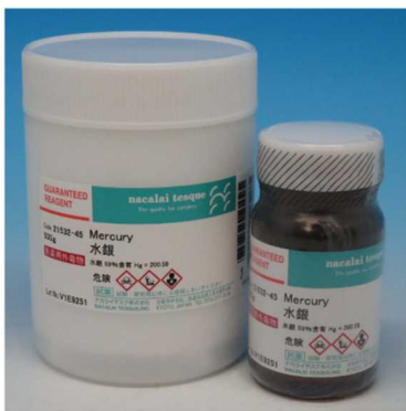
図 13 褐色ガラス瓶に密閉。 さらに、転倒、破損・漏洩防止のための緩衝材の入ったポリエチレン製の容器に密閉。
