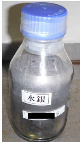
図 17 ガラス製の円筒形ねじ口びんに密閉し、容器表面に「水銀」と表示
