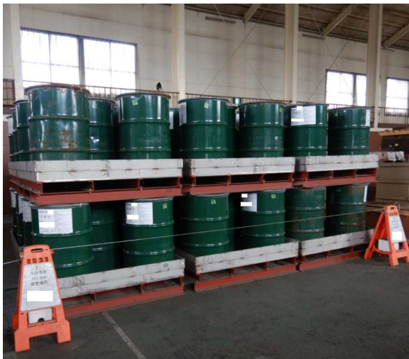
図 7 保管区域を決めて漏えい防止パレットに載せた状態
