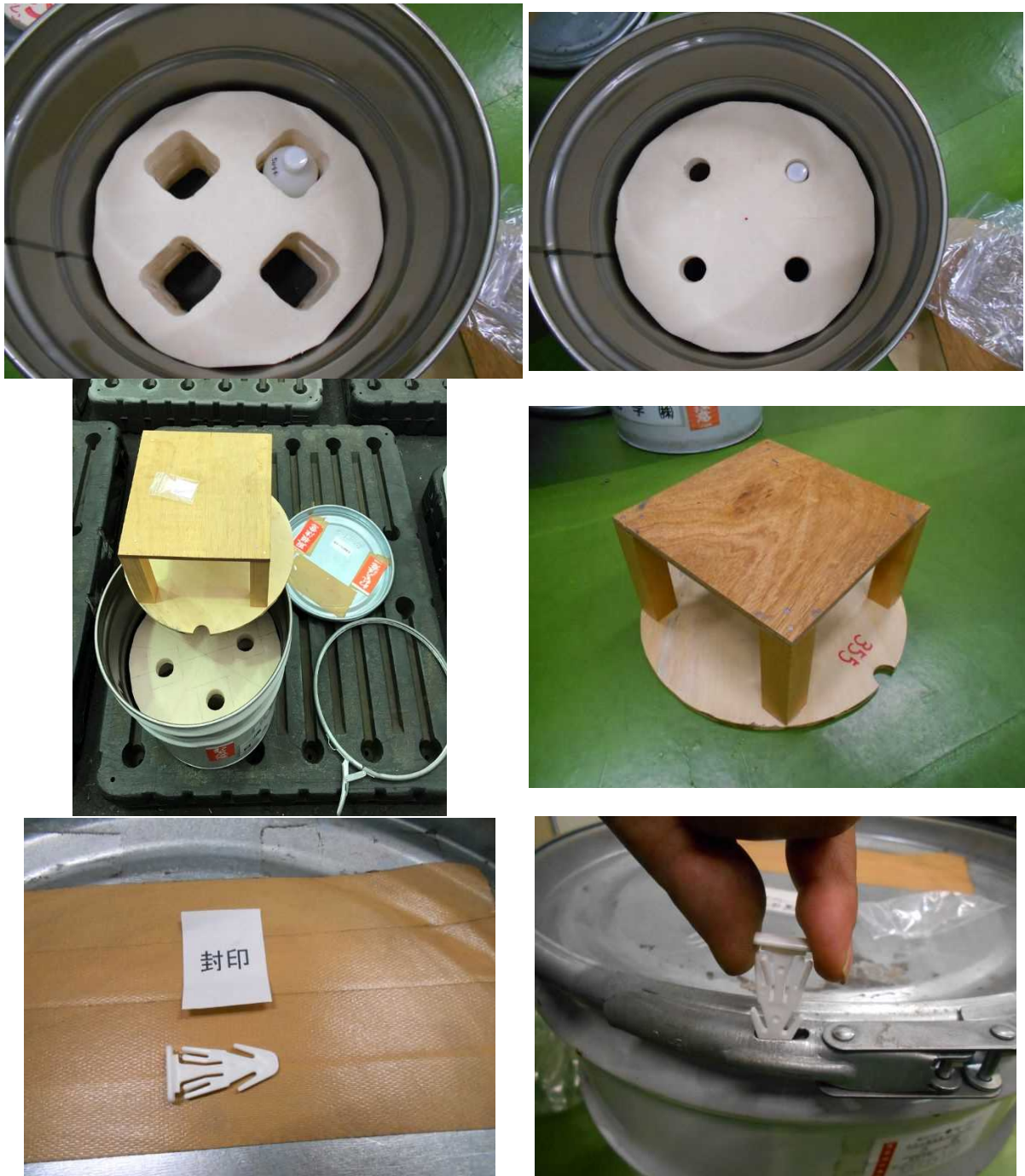
図 16 潰れ防止のための中蓋及び封印用鍵
