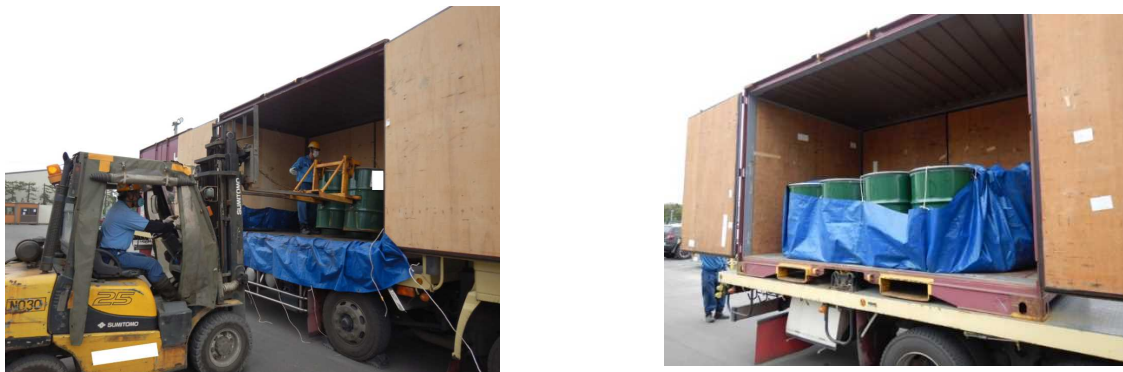
図 13 ドラム缶の積載の様子。シートで包むことで漏洩防止
