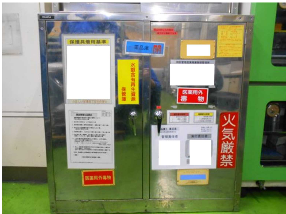
図 17 水銀含有再生資源保管庫の表示と施錠中の様子
