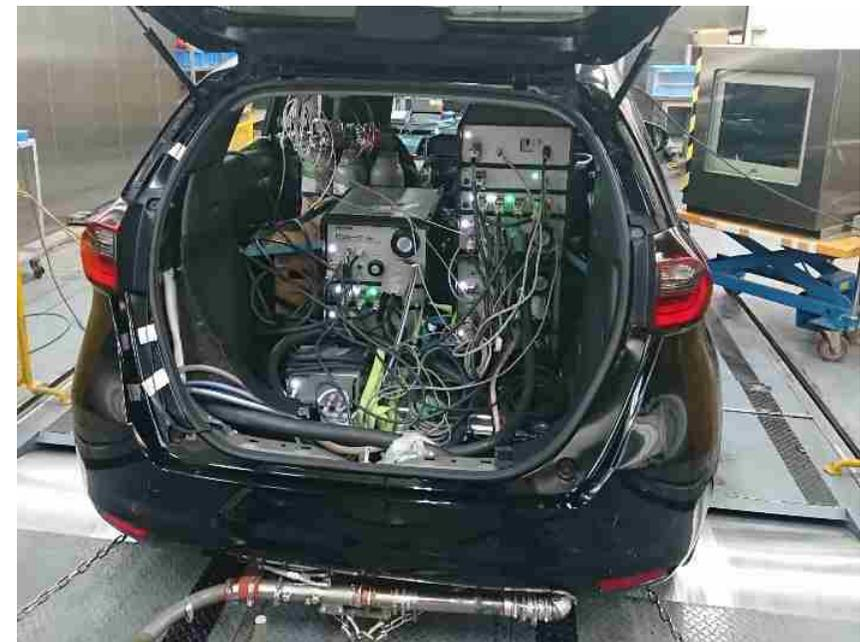
試験車両へのPEMSの取付状況
