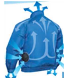
服の中に外気を取り入れる小型電動ファンを装備した作業服
