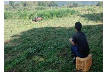
リモコン式草刈機 リモコン操作のため、木陰からの作業も可能となる
