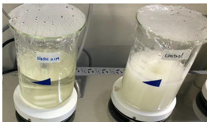
図 3-4 アルカリ添加による 100℃での溶解度の上昇 1
