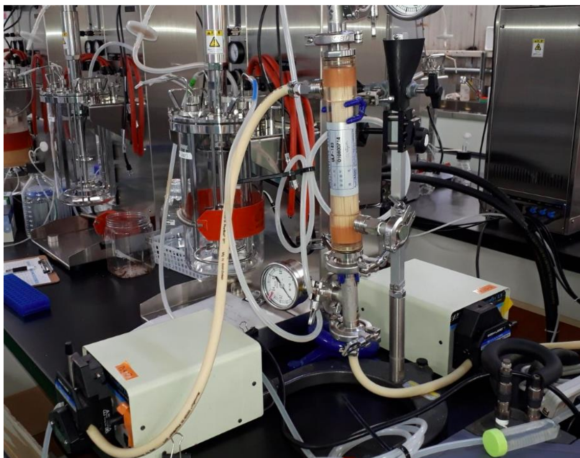
図 2-48 ラボで設置した半連続装置
