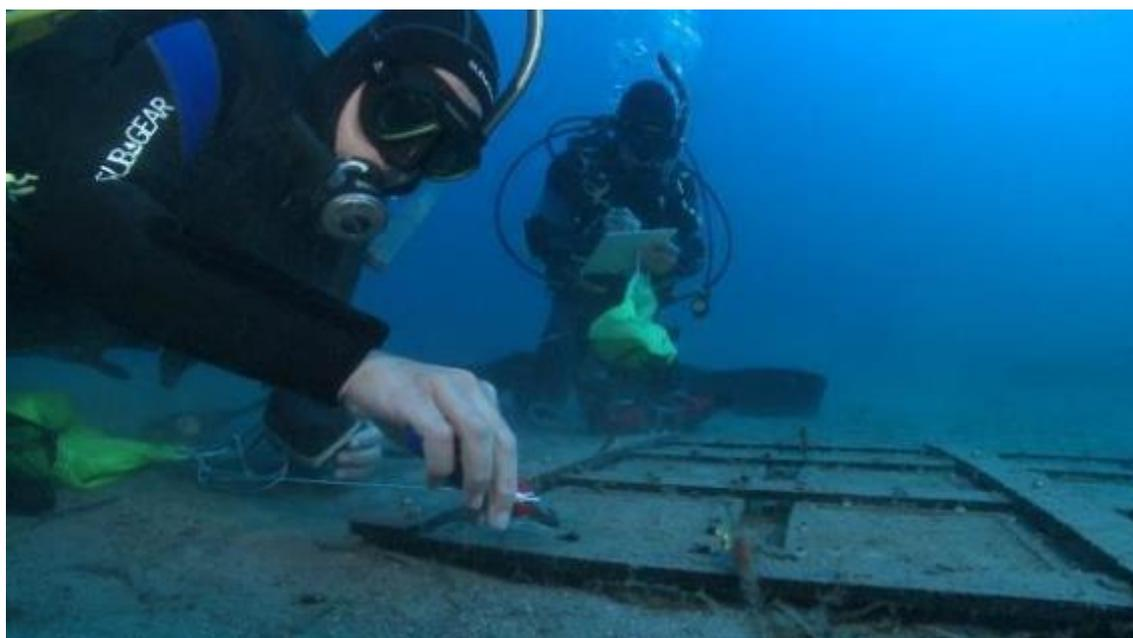
図 2 6 海底に生分解性プラスチック片を沈め経時劣化、分解速度、分解度合いを検証
