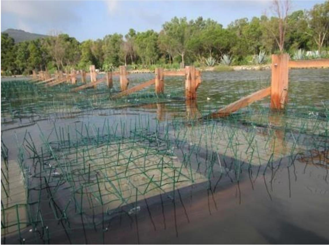
図 2 2 海岸で浮いているプラスチックを想定した際の生分解性試験
