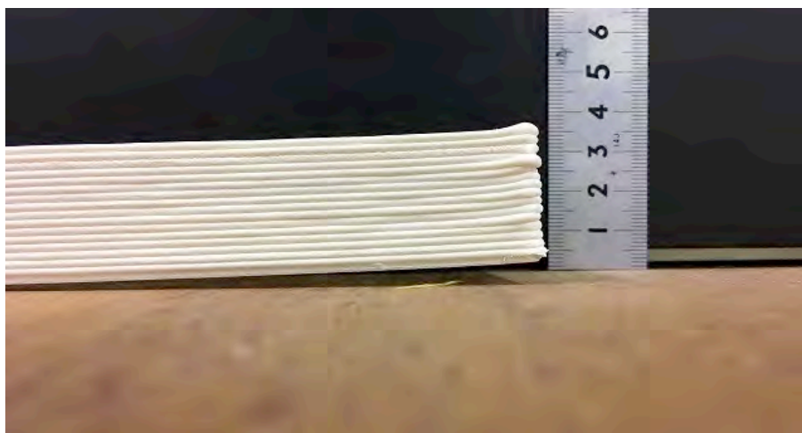
図 1-13. No.18. 紙パウダー（粒径 30\mu\text{m} ） 26.5%
