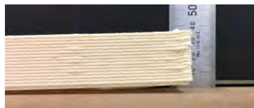
図 1-12. No.22. CF300 \mu m30%(左) No. 23. 300+400 \mu m30%(右) ニーダー+押出機加工
