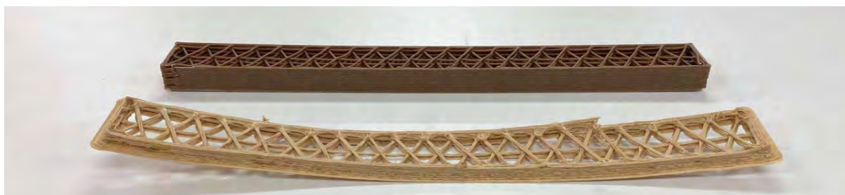
図 1-5. No.11. セルロースファイバー (CF) 400\mu\text{m} 40% 吸湿状態(下) No.11. CF 900\mu\text{m} 40%+乾燥処理(上)
