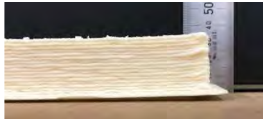
図 1-9. No. 16. CF400 \mu m30%(左) No. 17. CF 900 \mu m30%(右) 押出機
