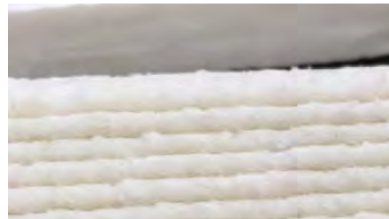
図 1-11. No.21. CF400 \mu m30%ニーダー+押出機加工
