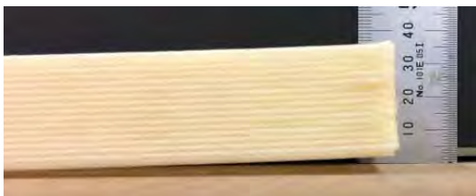
図 1-12. No.22. CF300 \mu m30%(左) No. 23. 300+400 \mu m30%(右) ニーダー+押出機加工
