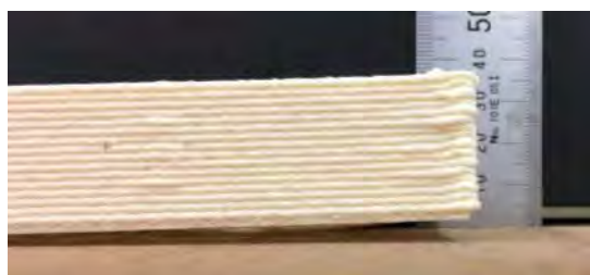
図 1-10. No.19. CF400 \mu m30%(左) No. 20. CF 300 \mu m30%(右) ニーダー加工
