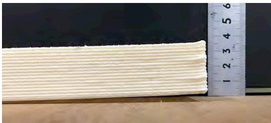
図 1-11. No.21. CF400 \mu m30%ニーダー+押出機加工
