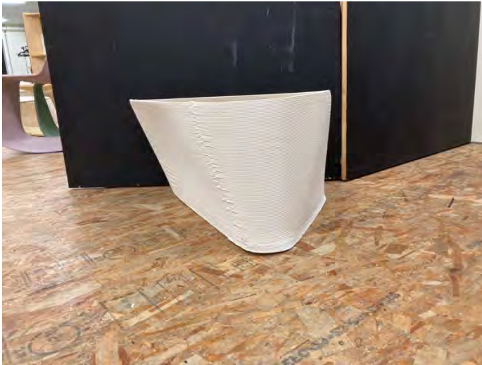
材料No.18 :紙パウダー 30% 3Dプリント製造後粉砕100%再生ペレット (プリント:6mm 2層、反りの抑制:△、色:白色、表面:ザラつきあり)
