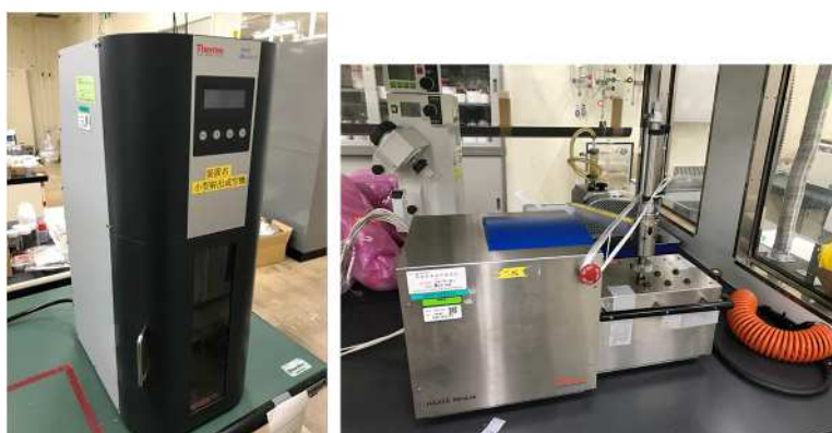
図 4-3 リサイクル性の確認に用いた小型射出成形機（左）、 およびラボ用小型2軸押出機（右）
