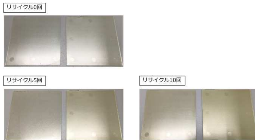
図 4-10 セルロースエステル誘導体 平板プレート外観写真 左側 1 mm t、右側 2 mm t
