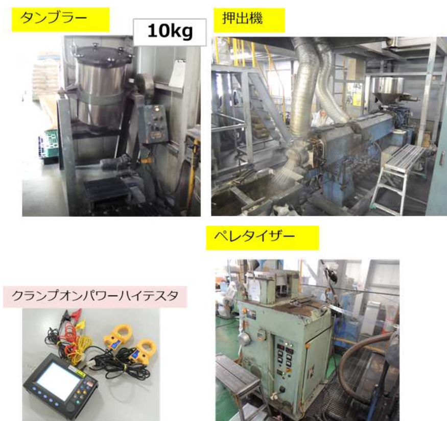
図 5-2 ペレット化 生産工程設備（小型機）
