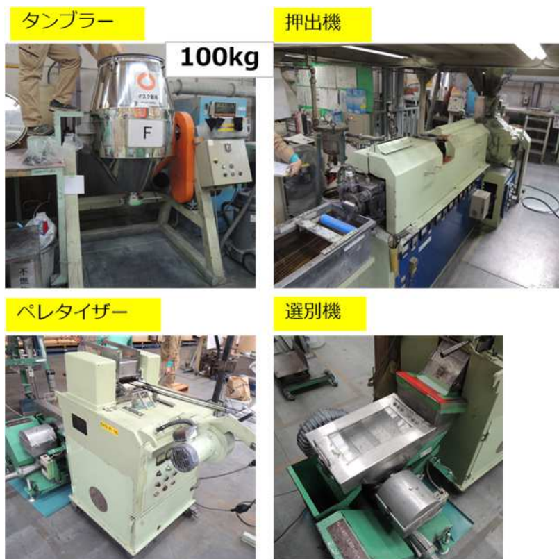
図 5-3 ペレット化 生産工程設備 (中型機)
