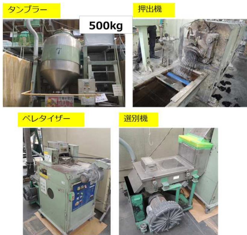
図 5-4 ペレット化 生産工程設備 (大型機)
