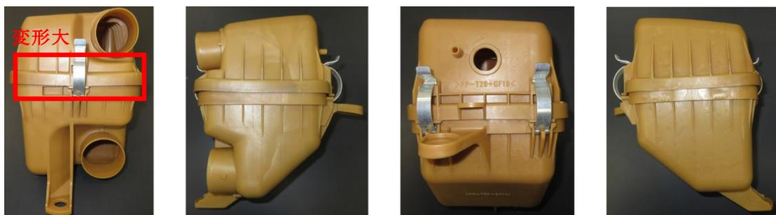
図7-18 冷熱サイクル試験後の外観
