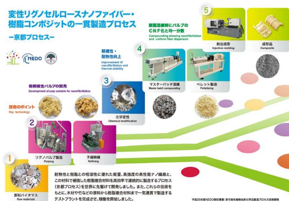
図 1-10 パルプ直接混練法：京都プロセス
