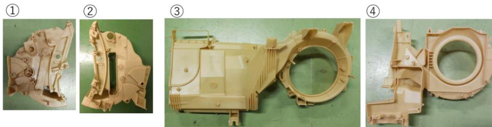
図 6-28 バイオ PE-CNF10 の成形品の外観
