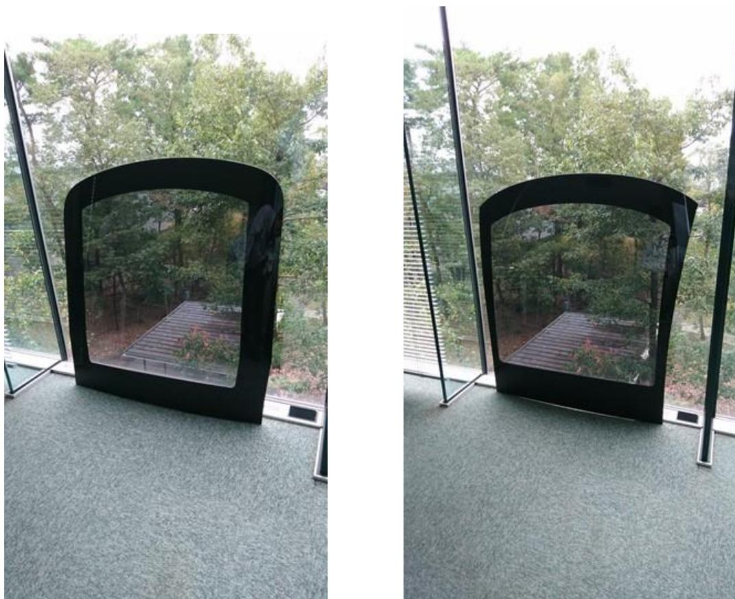
図3-10 ルーフパネル (左) とバックウィンドウ (右)
