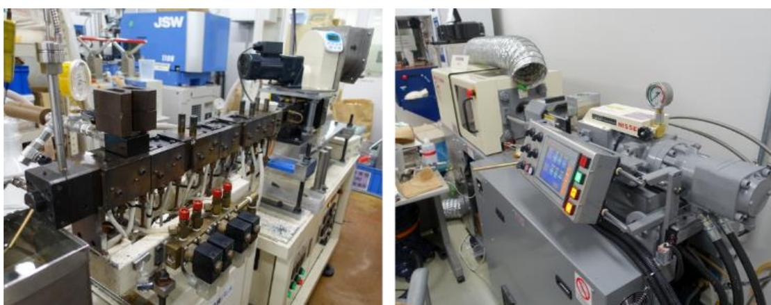
図 4-1 （左）二軸押出機及び（右）射出成形機
