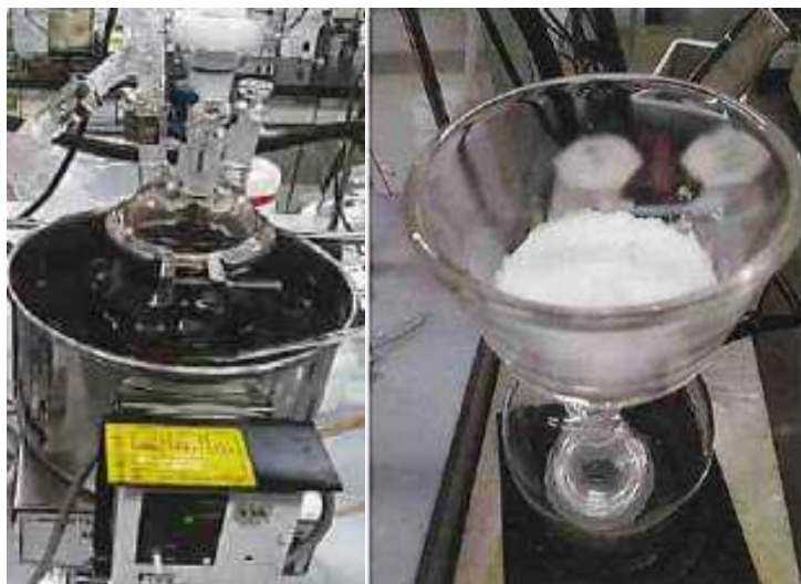
写真2-2-3-1 a-1 乳酸脱水ーオリゴマー合成ーラクチド化状況 （左：オリゴマー、右：精製ラクチド）
