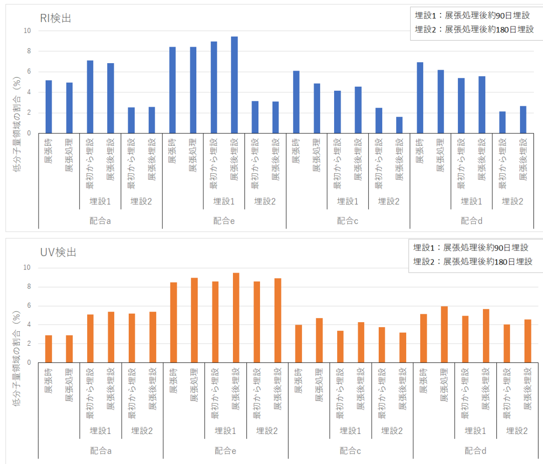
第17図 配合シリーズ1のフィルムのGPC通常分析 ー低分子量部分の割合ー
