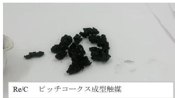
図 2.35 Re/C 成型触媒
