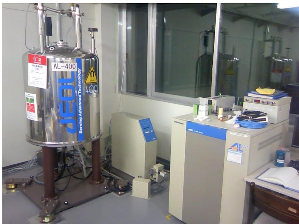
図3.37 測定に用いたNMR装置
