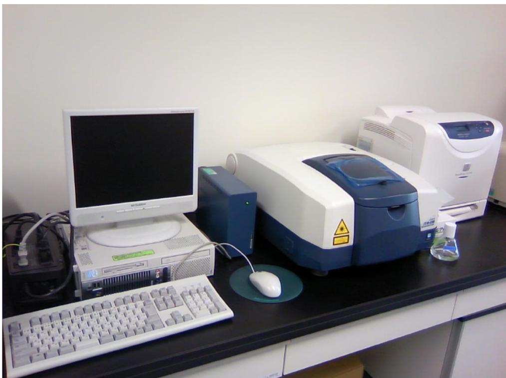
図3.40 測定に用いたFTIR装置
