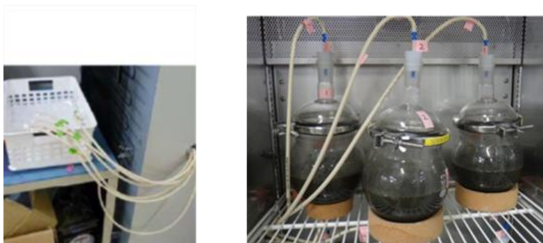
図 84 連続試験の様子（左：ガス袋、右：密閉反応容器）
