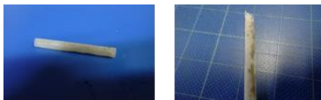
図 82 ストローの分解の様子（左から 7 日目、10 日目）
