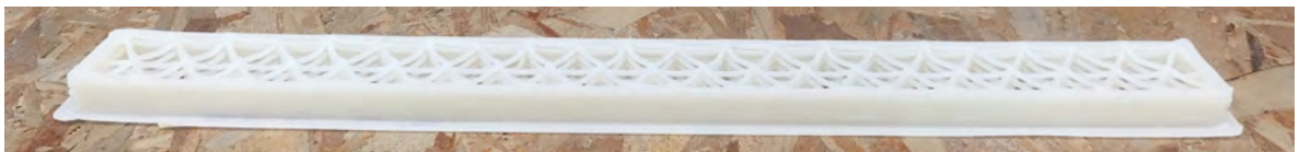
図 1-6. LDPE:SBC818 ベース 200 マイクロメートル 造形試験結果
