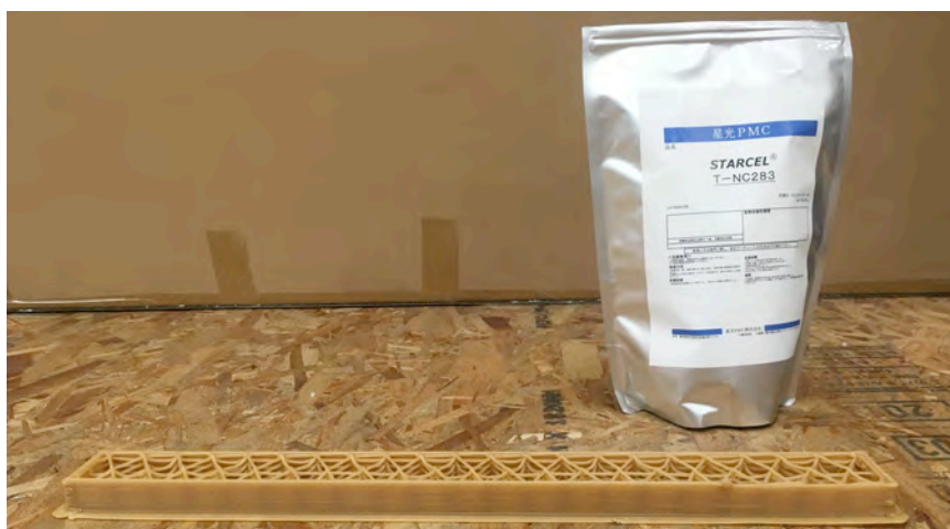
図 1-3. LLDPE ベース T-NC283 造形温度 210℃ 造形試験結果
