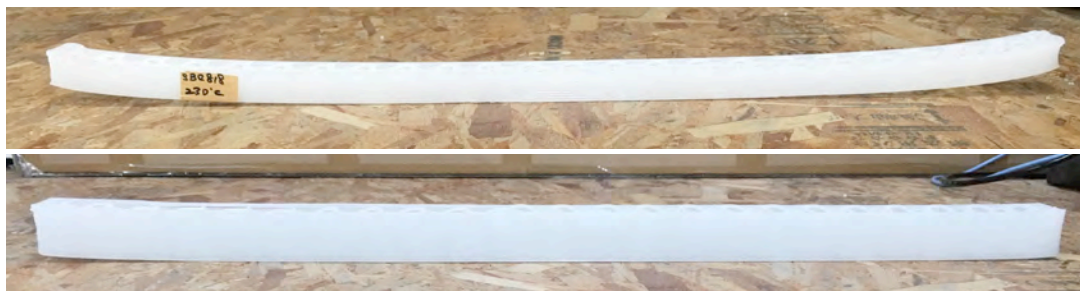
図 1-2. SBC818(上図)と PP/GW(下図)の比較:長さ 900mm の造形物。収縮の違いが分かる
