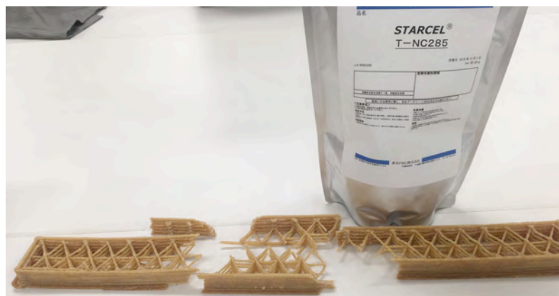
図 1-4. HDPE ベース T-NC285 造形温度 260℃ 造形試験結果
