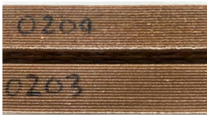
図 1-21. SBC818 / 木粉 1000 \mu\text{m} 以下(上)、SBC818 / 木粉 178 \mu\text{m} 以下(下)を比較
