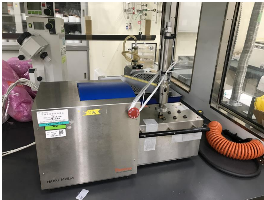
図 3-1 リサイクル性の確認に用いた小型射出成型機（上）、 およびラボ用小型 2 軸押出機（下）
