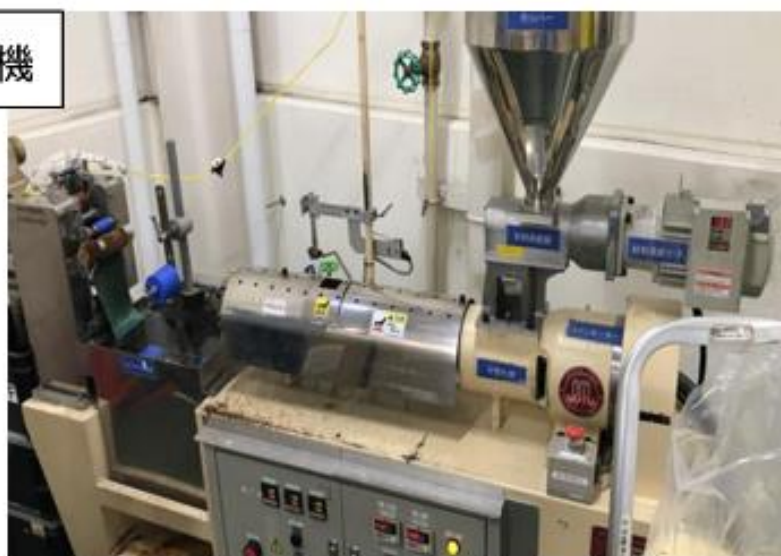
図 3-3 リサイクル性の確認に用いた中型粉碎機（上）と粉碎された バイオプラスチック（上右）、および1軸押出機（下）
