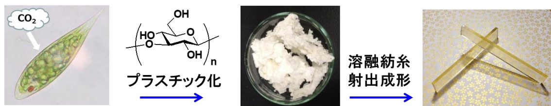
図 4-1 パラミロンエステル誘導体からの成形体作製
