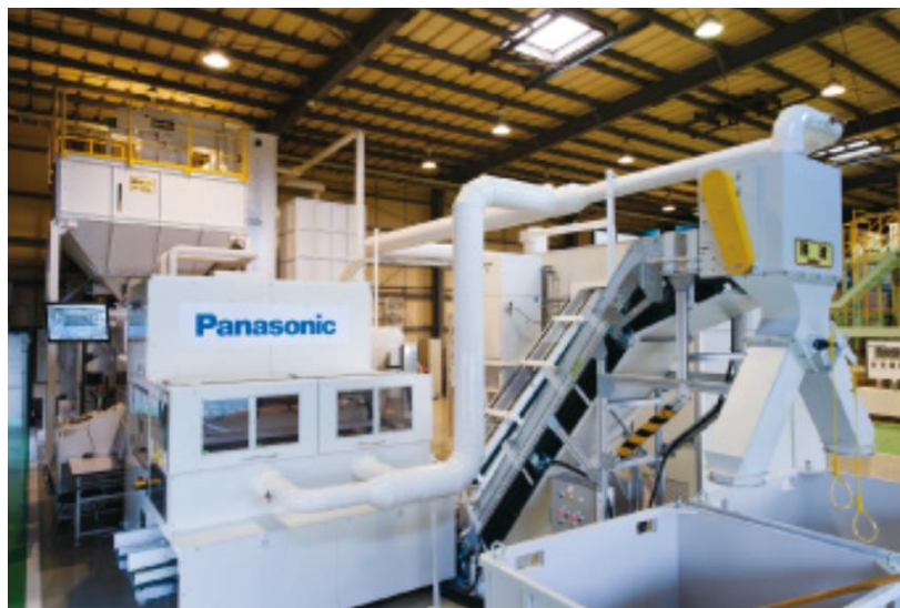
図 2-48 近赤外線樹脂選別機外観写真
