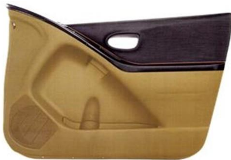
図3-9 ドアトリム (PP-CNF10%)
