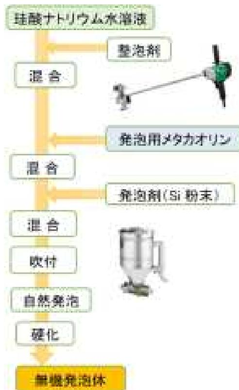
図 3-3 発泡ジオポリマーの製造工程
